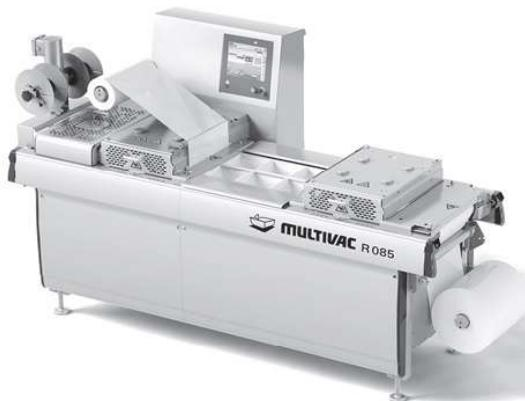
1970年代から日本でも普及している包装機で、フィルム熱成形→充填・盛付→真空・ガス置換・シール→フィルムカット、を一連で行う包装機である。
