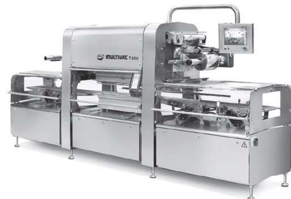
日本では比較的最近登場した包装機で、食品を盛り付けしたトレーを機械に供給すると、トレー搬送→真空・ガス置換・シール・カット→トレー搬出、を一連で行う包装機である。欧米では1990年代に普及が始まっていたが、ここ10～20年で急速に市場が拡大した。
