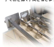
カッティングローラー(カバー有) 生地を希望のサイズにカットします。
